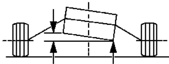
加速过猛时，车辆在一个方向上出现跑偏。减速时，车辆在另一个方向上出现跑偏。
